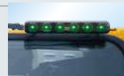
▲LED式ACS外部表示装置
